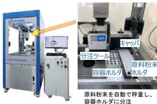
図2 材料調整自動化システムによる実験室の自動化
