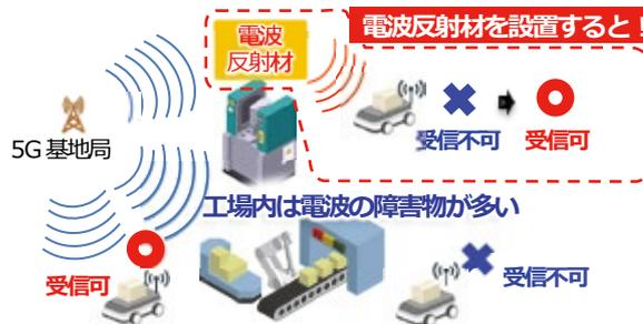
図1 工場内の電波環境と電波反射材による改善
