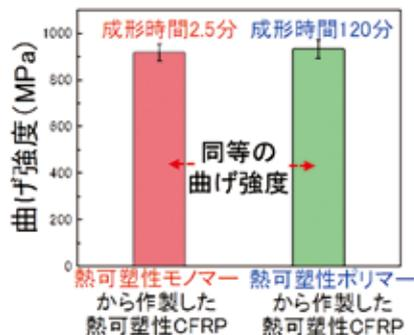
図2 曲げ強度試験結果
