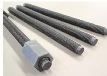
図1 開発した熱可塑性CFRPボルト
