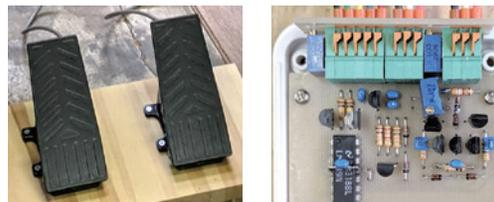
図1 フットコントローラと踏み量判断回路
