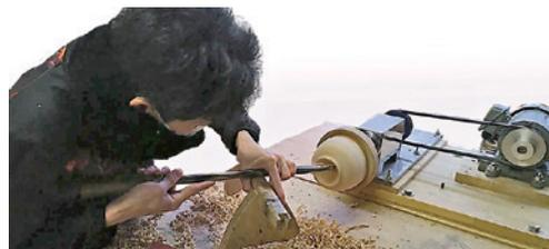
図2 電子制御方式ろくろによる木地挽き
