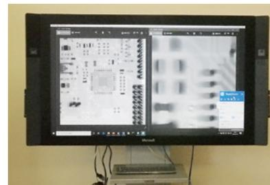
図3 情報共有機能による電子部品内部の不良チェック
