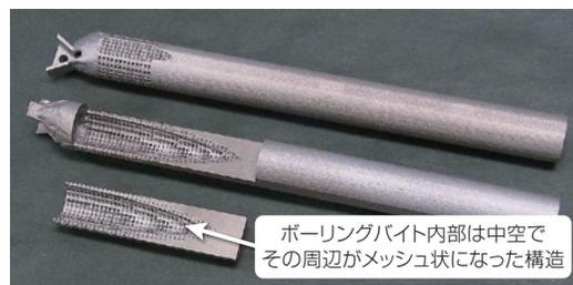
図2 最適化計算の結果をもとに金属3Dプリンタで造形したボーリングバイト
