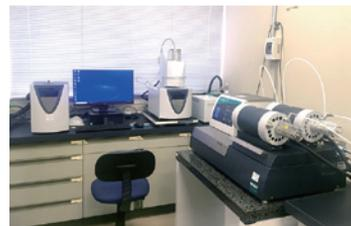
図 高温型熱分析装置の外観
