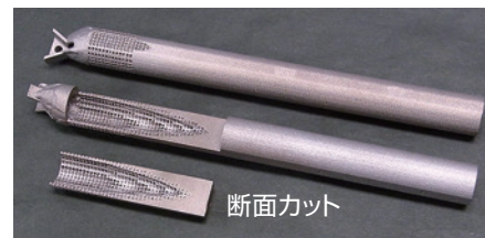
図2 最適化の結果をもとに3D造形したバイト
