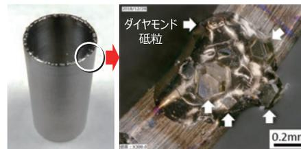
図2 試作した骨穿孔用中空工具
