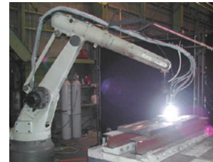
□ 新溶接材料で再生した押出スクリュー（左）と溶接施工の様子（右）
