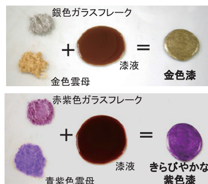
図2 光輝性顔料と漆を配合した例
