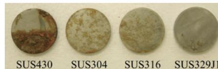
図1 中性塩水噴霧サイクル試験の結果(360時間)
