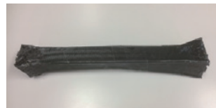
図1 組紐技術を用いて作製したCFRP
