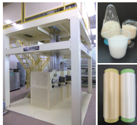
□ 溶融紡糸装置(左)と原料樹脂(右上)及び試作糸(右下)
