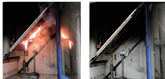
図1 漆塗り板の燃焼試験
