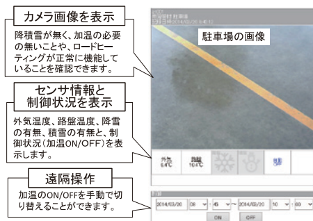
□ パソコンでの監視・制御画面の例
