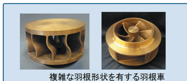
図3 3Dプリンタで造型した鋳造用鋳型を用いて開発を進める複雑形状品の例
