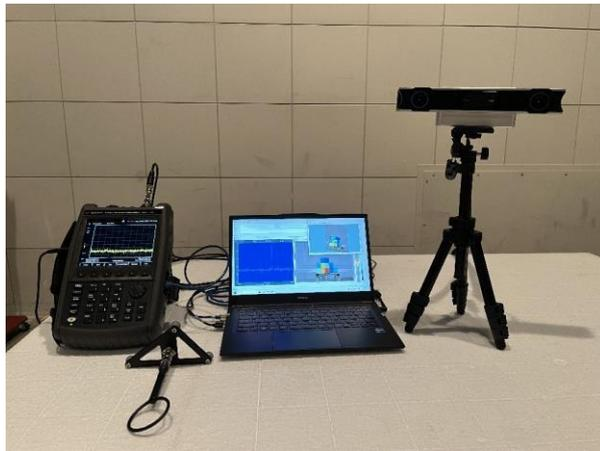
電磁放射分布計測装置
