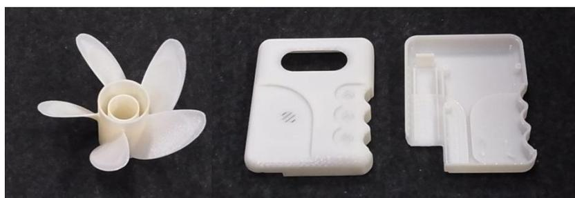
・機能検証用試作モデル（ファン、電気製品筐体）
