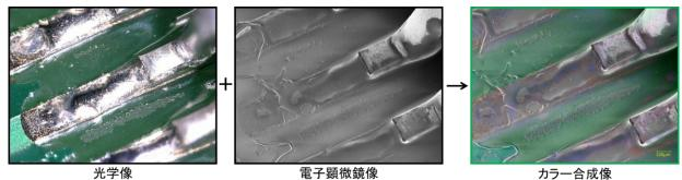
電子部品のはんだ付け箇所は上図(左)の光学像のように、端子やはんだ部等の金属光沢箇所がハレーションを起しやすく表面上のフラックスの状態が不鮮明なことが分かります。上図(中)の電子顕微鏡観察では、端子やフラックスの状態がはっきり観察できますが、光学像のような色情報はありません。上図(右)のように、光学像と電子顕微鏡像のカラー合成機能を使用すると、色情報を持った電子顕微鏡像のような鮮明な観察像が得られます。これにより、電子顕微鏡像では分からなくなる各材料の境界が色により明確に表示できます。
