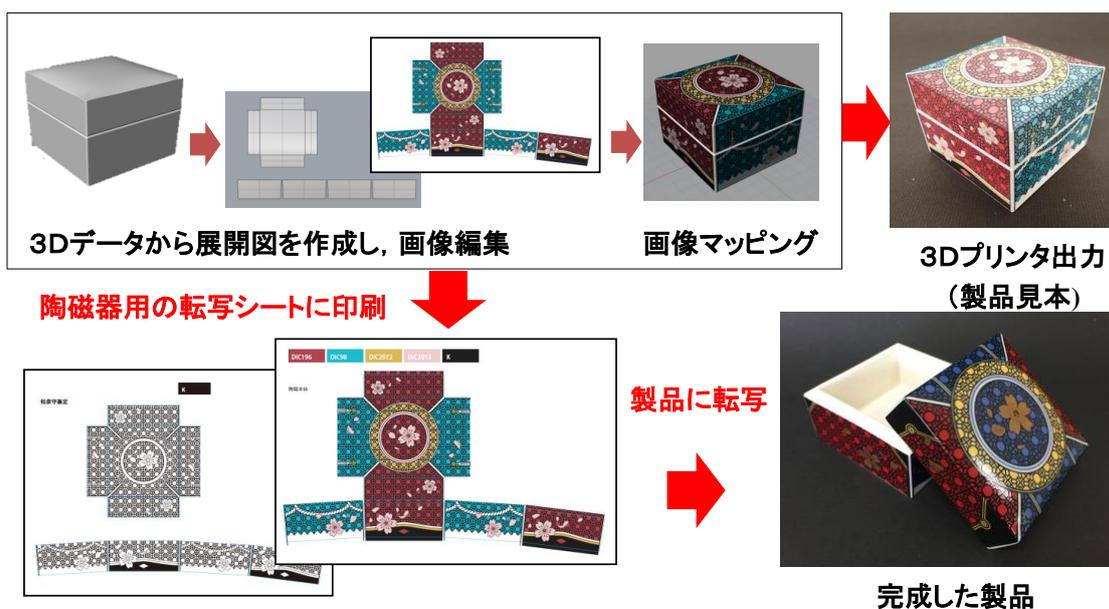
図13 九谷焼製品の転写シート開発への応用例
