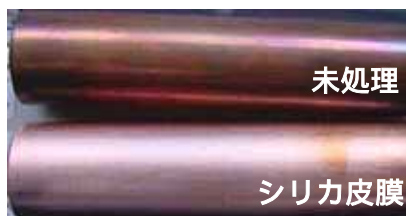
図2 塩水噴霧試験(48時間経過後)
