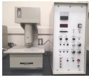
KES-FB3-A : 圧縮試験機
