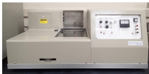
KES-FB2-A：純曲げ試験機
