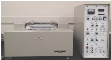
KES-FB1-A：引張りせん断試験機
