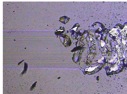
(b) 剥離部のスクラッチ痕観察結果
